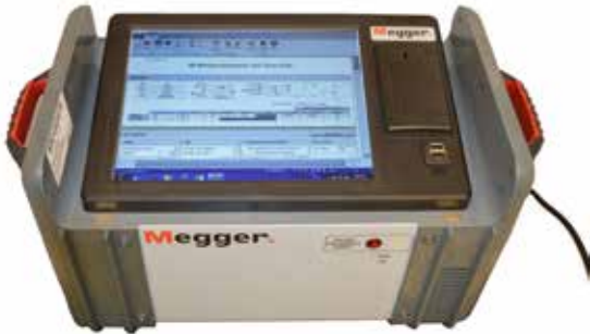
MWA330A со встроенным 12-дюймовым промышленным компьютером.
