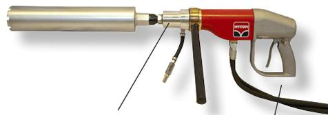
Стандартная круглая передняя панель диаметром 60 мм для удобной установки на стандартной стойке для легкой дрели
