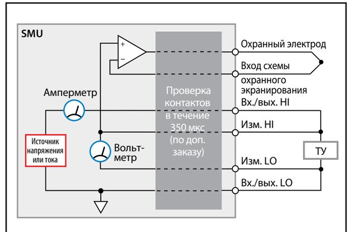
Рис. 12. Проверка качества контактов в источниках-измерителях серии 2400
