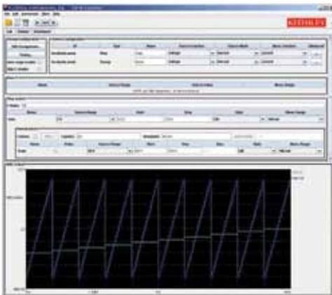
При необходимости быстрого сбора данных о корпусном тестируемом устройстве интерфейс дополнительно устанавливаемого программного обеспечения ACS Basic Edition с помощью мастера настройки позволяет легко найти и выполнить требуемый тест, например, показанный на рисунке типовой для полевого транзистора.
