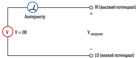
Напряжение источника = 0, измерение тока
