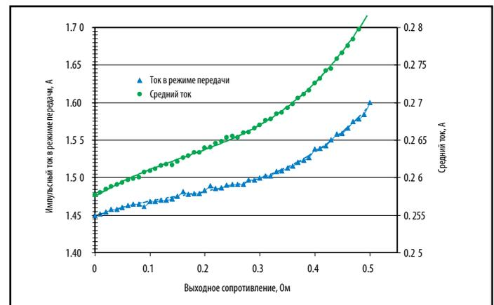
Рис. 5. Потребление тока в режиме передачи и среднее потребление тока радиочастотным усилителем мощности, работающем в импульсном режиме при питании от источника питания модели 2302 или 2306, имитирующего аккумуляторную батарею с номинальным выходным напряжением 3,60 В и выходным сопротивлением от 0,00 до 0,51 Ом.
