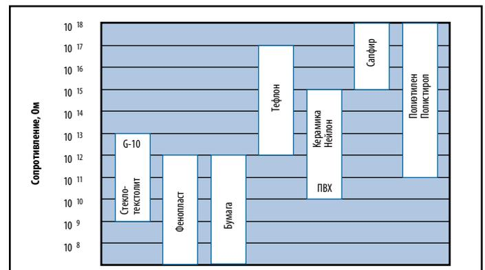
Рис. 8 Изоляторы
