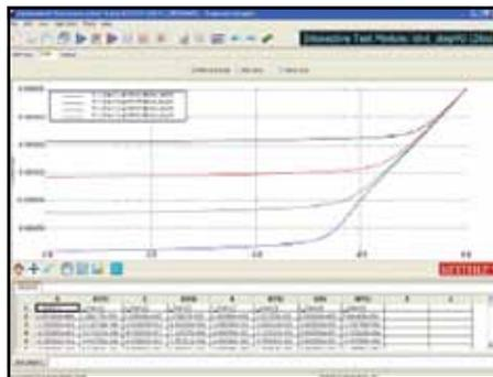
Как и традиционные аналоговые приборы для снятия характеристик, программный пакет ACS Basic Edition позволяет быстро получить семейство характеристик модуля, однако он дополнительно позволяет легко сохранять, сравнивать и анализировать результаты.
