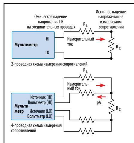
Рис. 5. Двухпроводная и четырехпроводная схемы измерения сопротивлений
