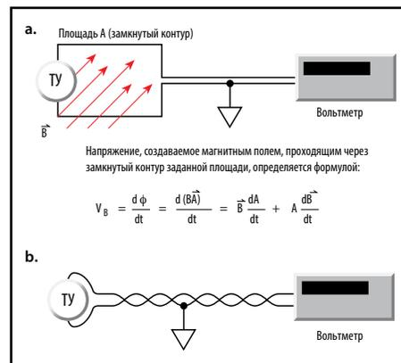
Рис. 3. Минимизация магнитных наводок путем применения витой пары
