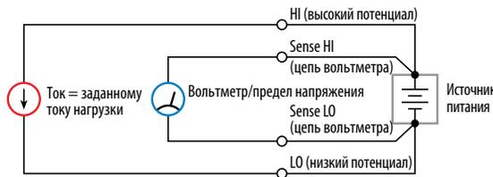
Входной ток = заданному току нагрузки, измерение напряжения, режим Remote Sense включен
