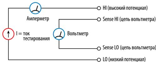
Ток источника = ток тестирования, измерение напряжения и тока, режим Remote Sense включен
