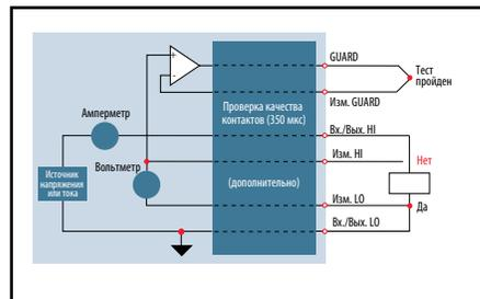
Рис. 6. Функция проверки контактов перед началом тестирования проверяет качество контактов питающих, измерительных и охранных цепей с тестируемым устройством.
