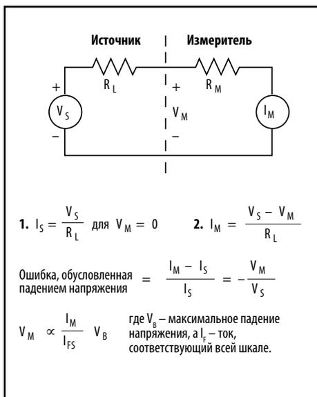
Рис. 4. Ошибка, обусловленная падением напряжения
