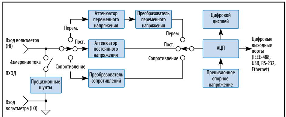
Рис. 1. Структурная схема цифрового мультиметра
