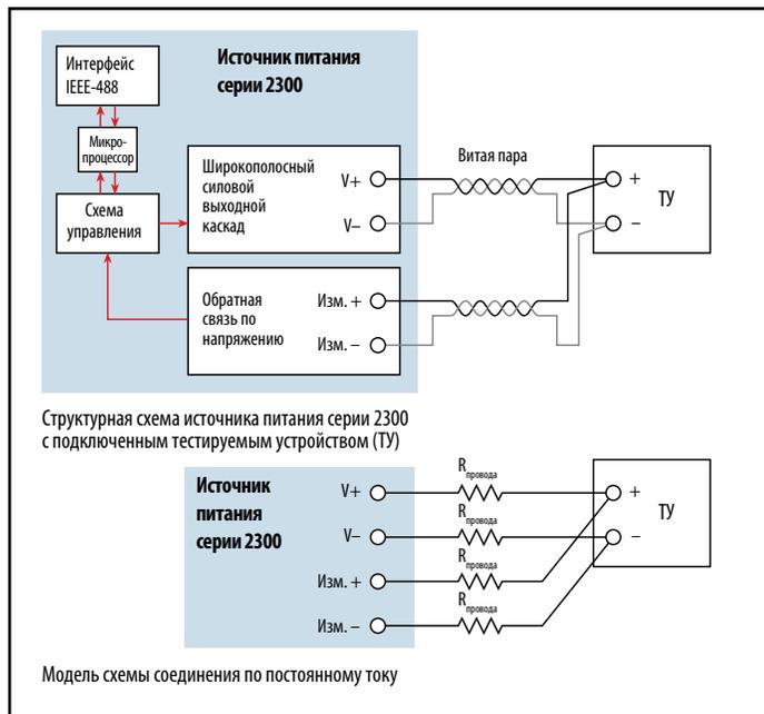
Рис. 4. Четырехпроводная схема подключения, используемая в источниках питания серии 2300, обеспечивает приложение к нагрузке точного напряжения
