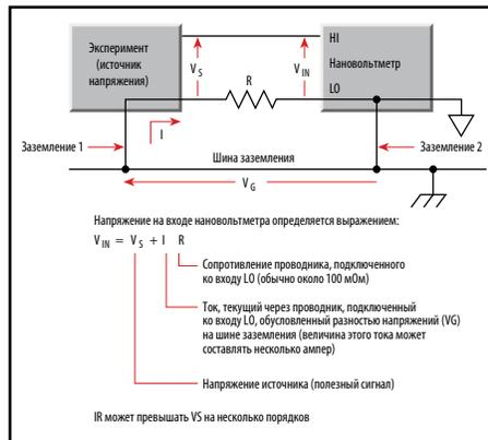
Рис. 2,а. Влияние нескольких точек заземления (контура заземления)
