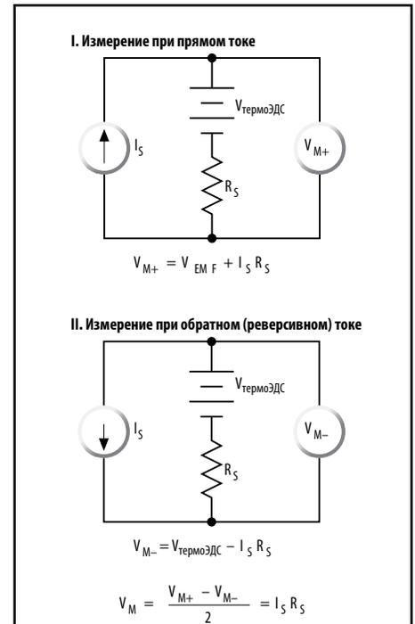
Рис. 5б. Учет термоэлектрических напряжений V\_термоЭДС в методе реверсивных токов
