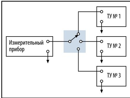
Рис. 5. Сканирующий переключатель
