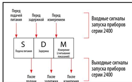
Рис. 10. Схема входных и выходных сигналов запуска приборов серии 2400
