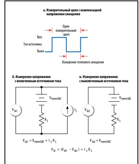
Рис. 5а. Учет термоэлектрических напряжений V\_термоЭДС в методе компенсации напряжения смещения
