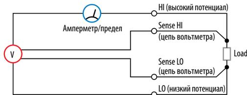
Источник напряжения, измерение тока, режим Remote Sense включен
