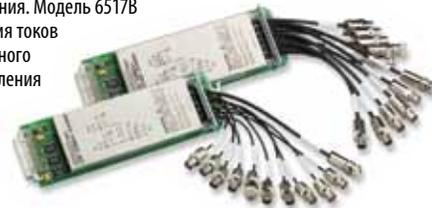
Платы 10-канальных мультиплексов моделей 6521 и 6522. Устанавливаются в слот расширения модели 6517B, расположенный на задней панели, для многоканального измерения малых токов
