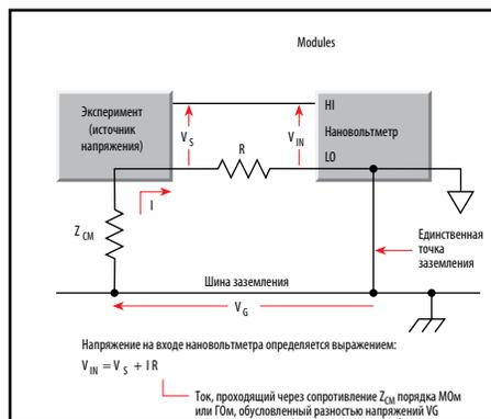
Рис. 2,б. Измерительная цепь с одной точкой заземления
