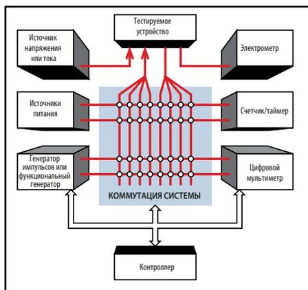
Рис. 1. Состав универсальной системы тестирования
