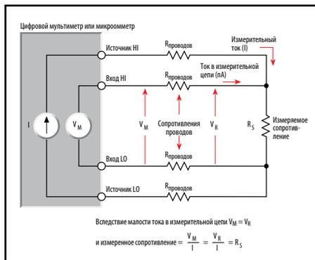
Рис. 4б. Четырехпроводная схема подключения для измерения сопротивлений
