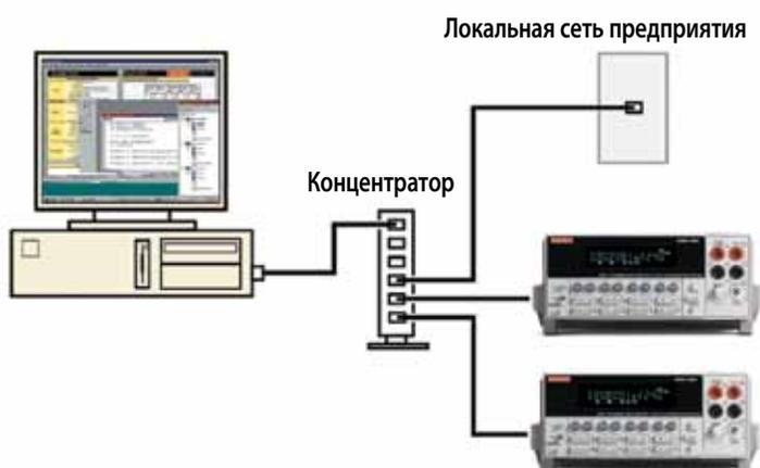
Цифровой мультиметр и система сбора данных модели 2701 с интерфейсом Ethernet – это первое средство измерения метрологического класса, сочетающее в себе высочайшую достоверность измерений и возможность управления и обмена данными в информационных сетях. Построенная на основе современного 22-разрядного интегрирующего АЦП, модель 2701 имеет разрешение 6½ разрядов и подключается к сети непосредственно через интерфейс Ethernet, как и любой компьютер.
