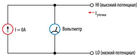
Ток источника = 0, измерение напряжения
