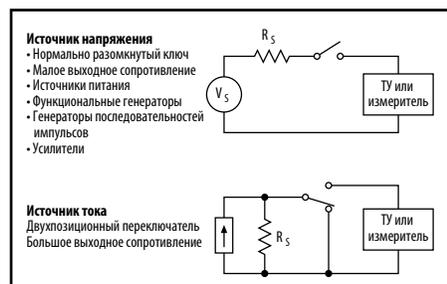
Рис. 2. Примеры конфигураций коммутационных элементов
