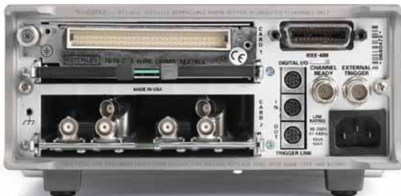
Задняя панель модели 7001 с установленными платами коммутации
