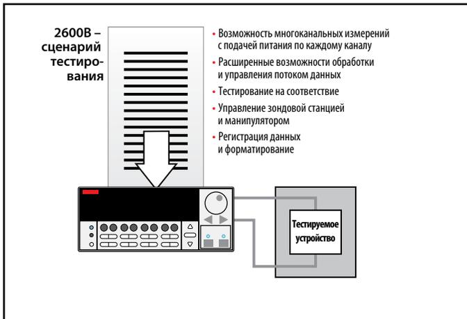
Рис. 11. Пример сценария тестирования для источника-измерителя серии 2600
