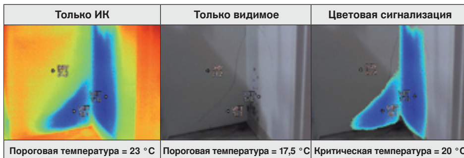
Рис. 3. При помощи цветовой сигнализации можно выделить определенную температуру инфракрасными цветами, а оставшееся изображение видимыми черно-белыми
