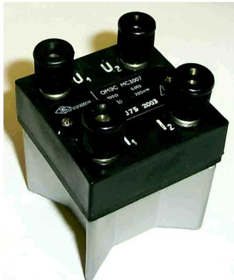
Предназначены для применения в качестве государственных эталонов, образцовых и рабочих мер в цепях постоянного и переменного тока в воздушной или жидкостной (конденсаторное масло, керосин, кремниоргамическая жидкость) средах.
